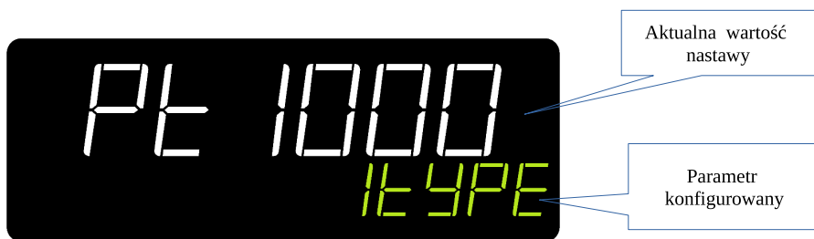
Rys. 8: Wygląd menu podczas nastawiania parametru.
